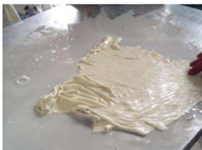
Figura 29: Proceso de depilado con espátula y piel lista para el desencalado.
