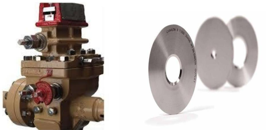
En este puente pasa el gas limpio, y al reducirse el diámetro por la placa que tiene puesta se produce una diferencia de presiones, antes y después de la placa orificio. Esta diferencia de presión es el principal dato para calcular el caudal de gas.
