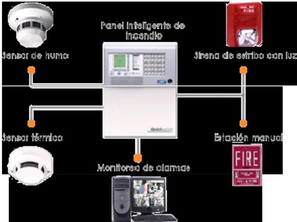
*Ejemplo de un Sistema de Detección automática de*
